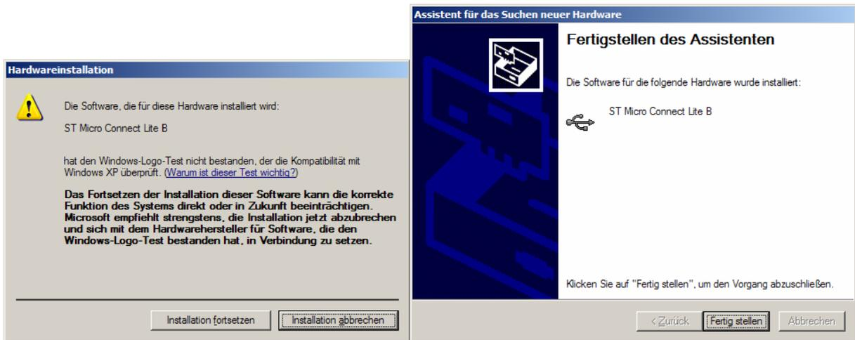
Den passenden Treiber für den virtuellen COM-Port des FT2232H Chips findet der Hardware-Installation-Assistent nicht automatisch und man muss die Treiber von STMicroelectronics, die unter **C:\STM\STMCR1.6.0\drivers\stmclite** installiert wurden, manuell vorgeben, die Installation der nicht signierten Treiber zulassen und neuere Dateien durch die älteren ersetzen lassen:
